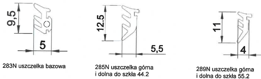
Rysunek B22. Uszczelki do osadzania wypełnień
