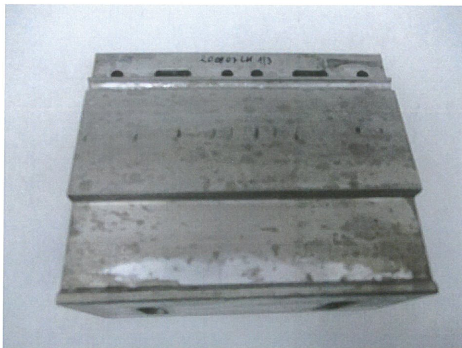
Fot. 3. Próbką 200807LK1/3 po starzeniu przez 720 h w komorze solnej
