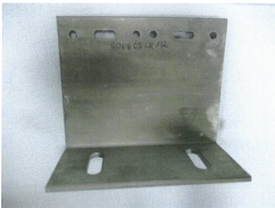
Fot. 6. Próbką 200807LK1/2 po starzeniu przez 1440 h w komorze solnej
