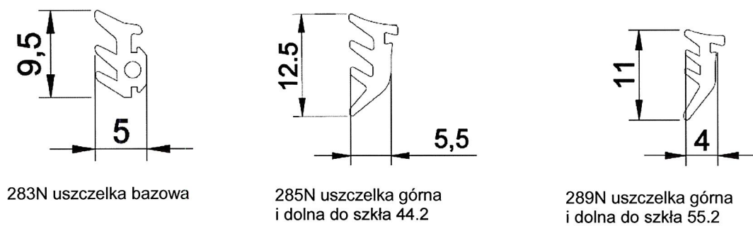
Rysunek B17. Uszczelki do osadzania wypełnień
