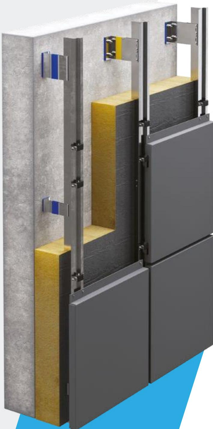
Das eingehängte Unterkonstruktionssystem BSP KWRV ist ein System zur mechanischen Befestigung von Kassettenpaneelen, in der Regel aus Verbundwerkstoff, Aluminium oder Stahl, an Außen- und Innenfassaden in der hinterlüfteten Fassadentechnik. Das System umfasst die folgenden Elemente:
