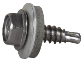
Rysunek A.32 Wkręty samowiercące, typ (4,8x19) mm z podkładką ze stali nierdzewnej z uszczelką EPDM
