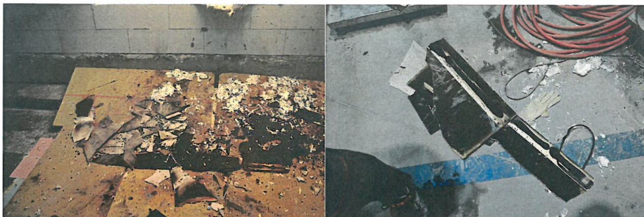
Rys. 22. Widok próbki podczas badania, elementy które odpadły – 70 minuta
