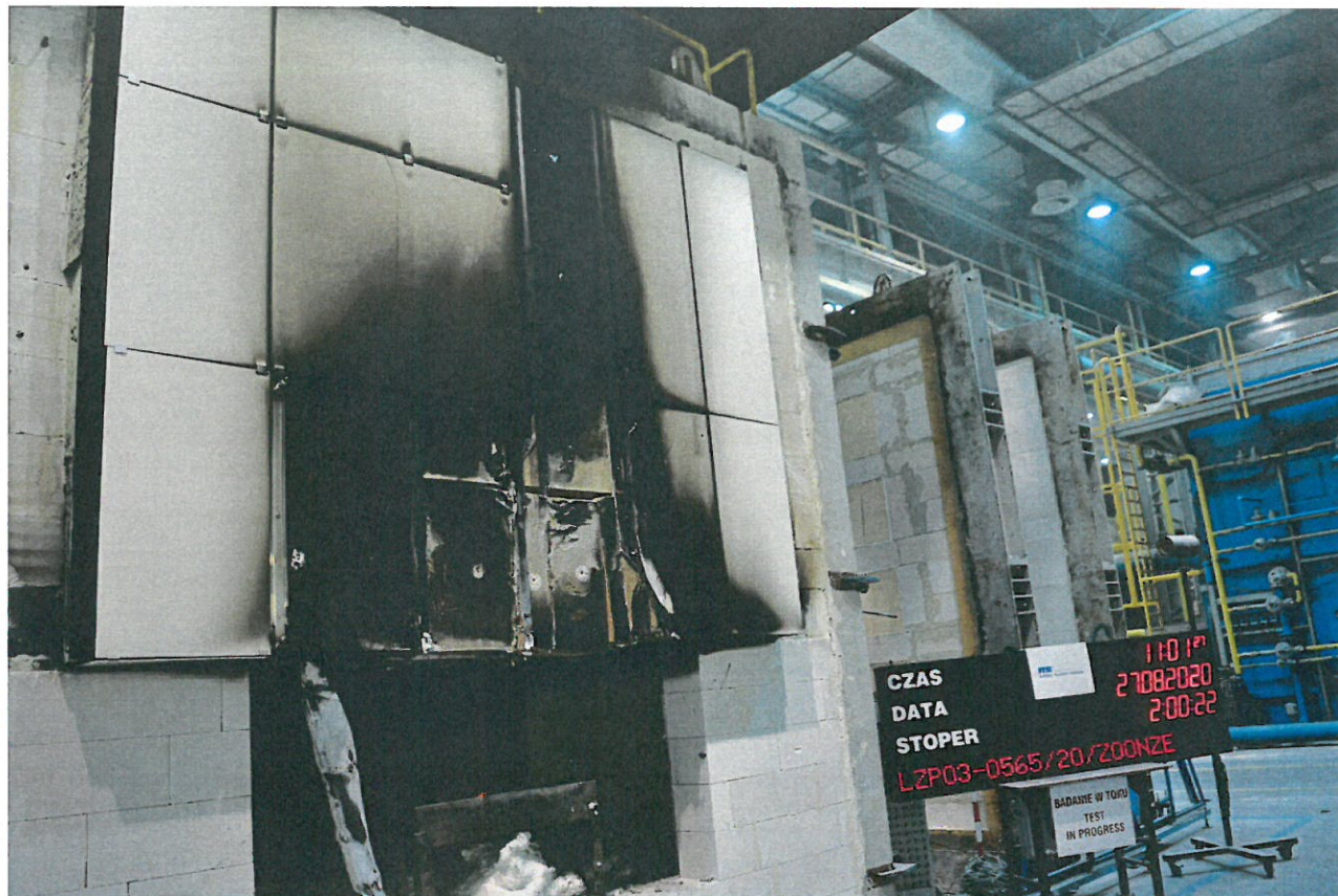
Rys. 25. Widok próbki po badaniu – 121 minuta
