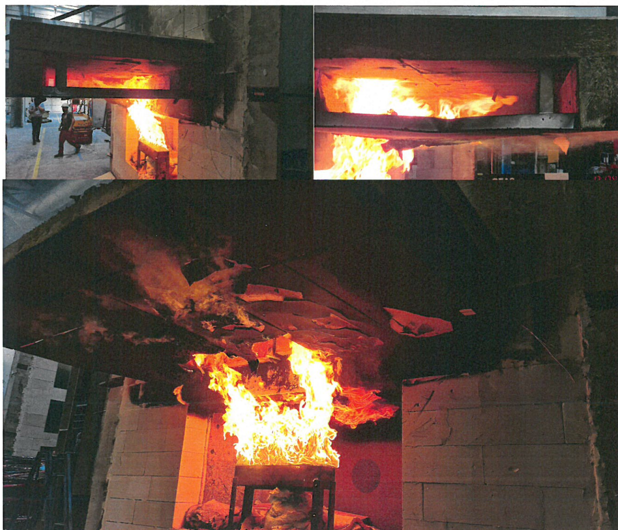
Rys. 14. Widok próbki podczas badania – 8 minuta – widać huszczenie i odpadanie okładzin
