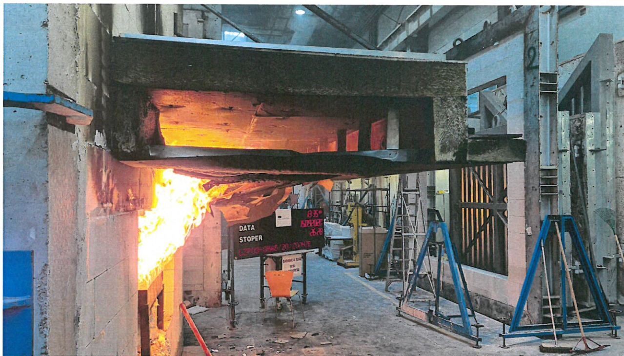
Rys. 17. Widok próbki podczas badania – 27 minuta – drobne elementy które odpadły
