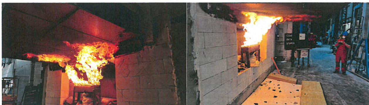
Rys. 12. Widok gotowej próbki przed rozpoczęciem badania. Po lewej okładziny HPL, po prawej włóknisto-cementowe
