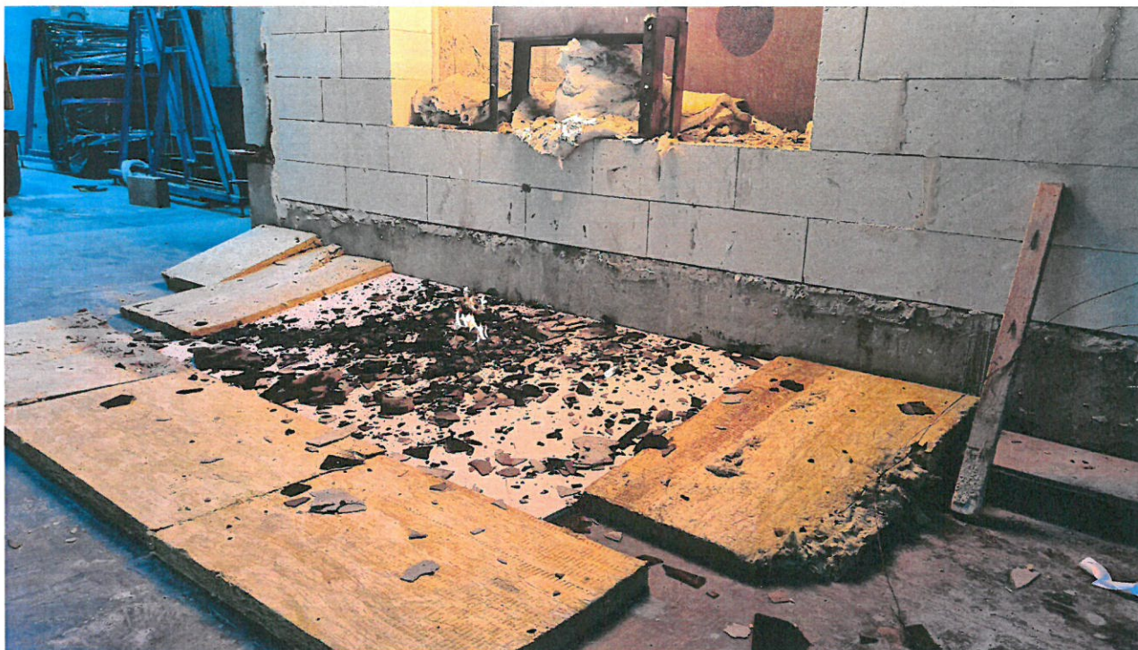
Rys. 15. Widok próbki podczas badania – 8 minuta – drobne elementy które odpadły
