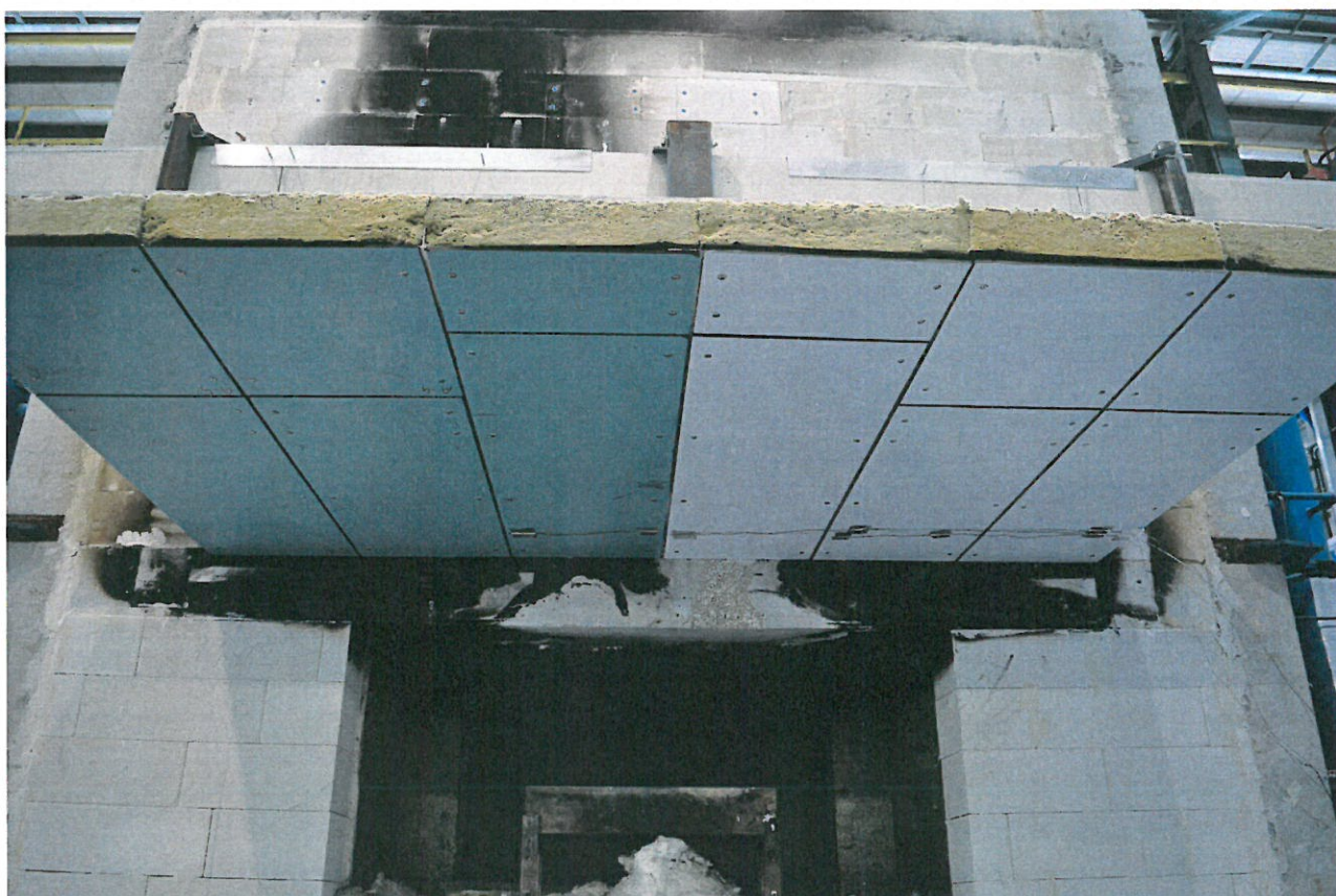
Rys. 12. Widok gotowej próbki przed rozpoczęciem badania. Po lewej okładziny HPL, po prawej włóknisto-cementowe
