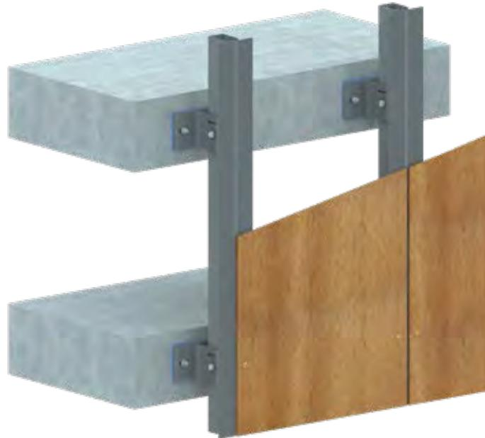
Das System BSP FTF (anders Etagensystem oder sog. floor to floor) wurde zwecks einer Minimalisierung der Anzahl der Punkt-Befestigungen zwischen der Fassade und der Wand des Gebäudes projiziert.
