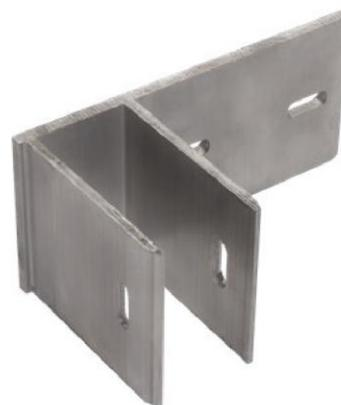
Кронштейн K2 LOS - подвижный, в стандартном исполнении имеет овальное отверстие размером 30x11 мм. Предназначен для крепления стойки фасада винтом M10. Кронштейн LOS не передает нагрузку от собственного веса фасада, поэтому в большинстве случаев он может быть меньше несущего кронштейна. По желанию заказчика можно выполнить любые отверстия на нашем станке с ЧПУ.
