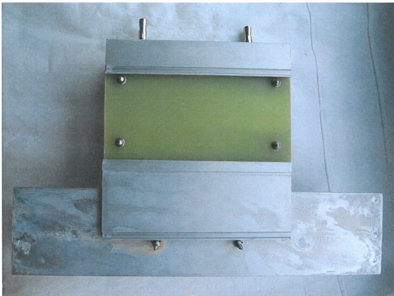
Fot. 2. Konsola pasywna BSP KW PAS po ekspozycji na działanie kwaśnej mgły solnej w czasie 1500 godz.
