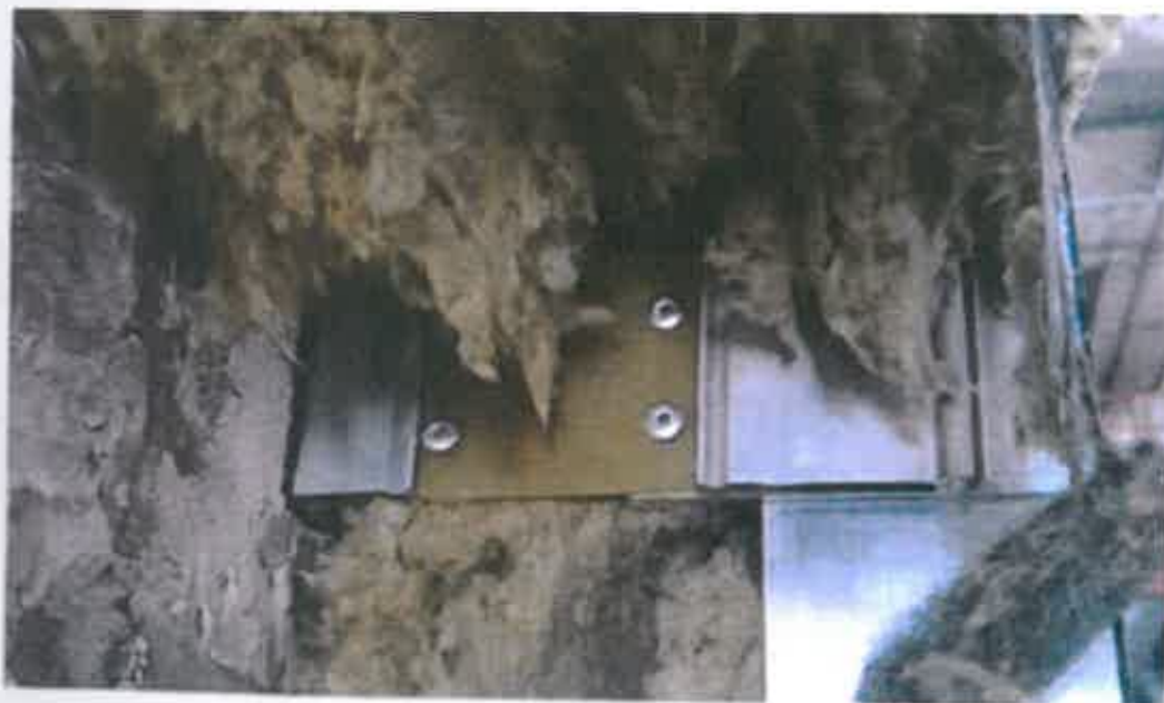
Fot.1 Konsola pasywna po badaniach wykonanych na potrzeby opinii [3.8] (archiwum ITB)
