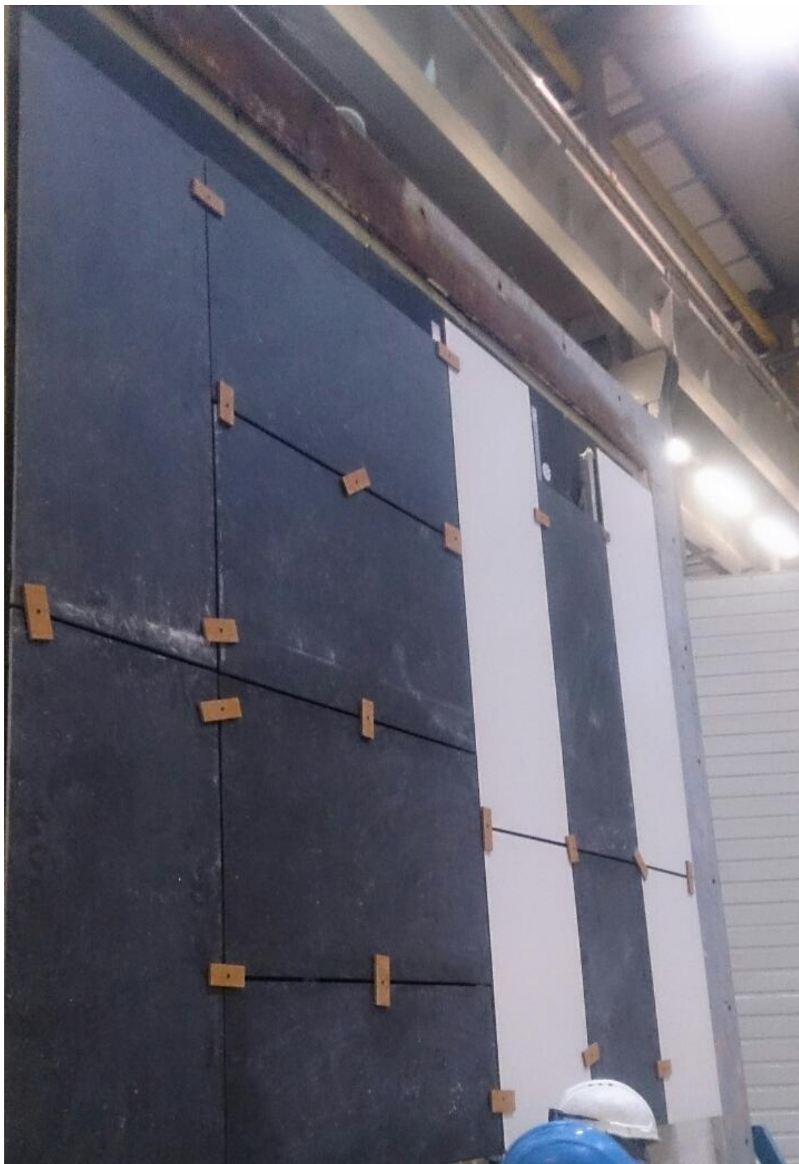
Rys. 6. Widok elementu próbnego przed badaniem (widoczne tymczasowe elementy przytrzymujące zostały zdemonstowane przed startem badania)
