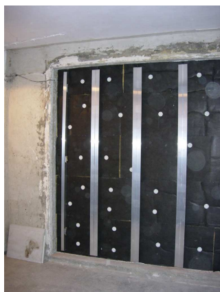
Fot.4. Ściana bazowa z izolacją systemową BSP Bracket System Polska, zamontowana w otwór badawczy komór sprzężonych. Od lewej: widok ocieplenia w trakcie montażu, widok gotowej przegrody - próbka nr 3.
