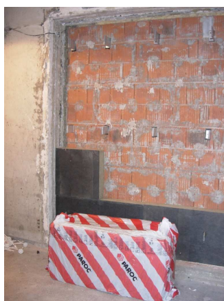
Fot.5. Ściana bazowa z izolacją systemową BSP Bracket System Polska, zamontowana w otwór badawczy komór sprzężonych. Od lewej: widok ocieplenia w trakcie montażu, widok gotowej przegrody - próbka nr 4.
