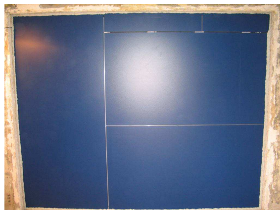
Fot.4. Ściana bazowa z izolacją systemową BSP Bracket System Polska, zamontowana w otwór badawczy komór sprzężonych. Od lewej: widok ocieplenia w trakcie montażu, widok gotowej przegrody - próbka nr 3.
