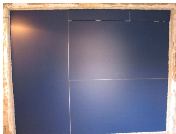
Fot.5. Ściana bazowa z izolacją systemową BSP Bracket System Polska, zamontowana w otwór badawczy komór sprzężonych. Od lewej: widok ocieplenia w trakcie montażu, widok gotowej przegrody - próbka nr 4.
